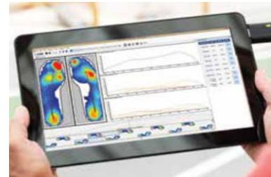
Técnica de dinamometría en base a la medición de presiones (fuerzas externas), mediante plantillas de presión plantar. Estos dispositivos ofrecen mapas gráficos y digitales de presión que permiten analizar la marcha.
