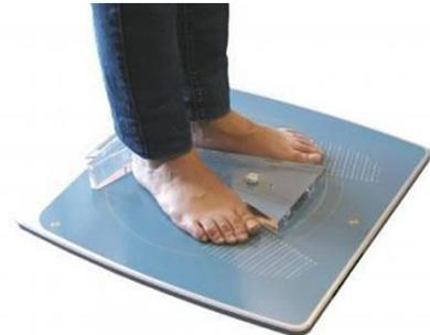
Plataforma normalizada especialmente diseñada para el completo análisis posturográfico y del equilibrio. Fabricada en aluminio y con un peso de 8 kg resulta muy sólida y estable a la vez que portátil. Dispone de un sistema de sensores de 3 puntos y soportes ajustables que compensan cualquier irregularidad del suelo, lo que permite un análisis de gran exactitud y precisión de 0,1mm.
